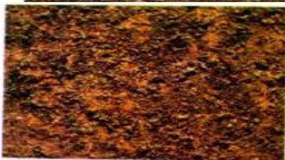
Figura 24. Grados de oxidación. Fuente, ISO 8501-1, Grados de óxido y de preparación de substratos de acero no pintados después de eliminar totalmente los recubrimientos anteriores.
