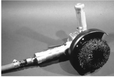
Figura 4. Cepillo de alambre rotatorio. Herramienta mecánica empleada en la limpieza de estructuras. Fuente, NACE, Descripción General de la Preparación de la Superficie, 2007, p.37.
