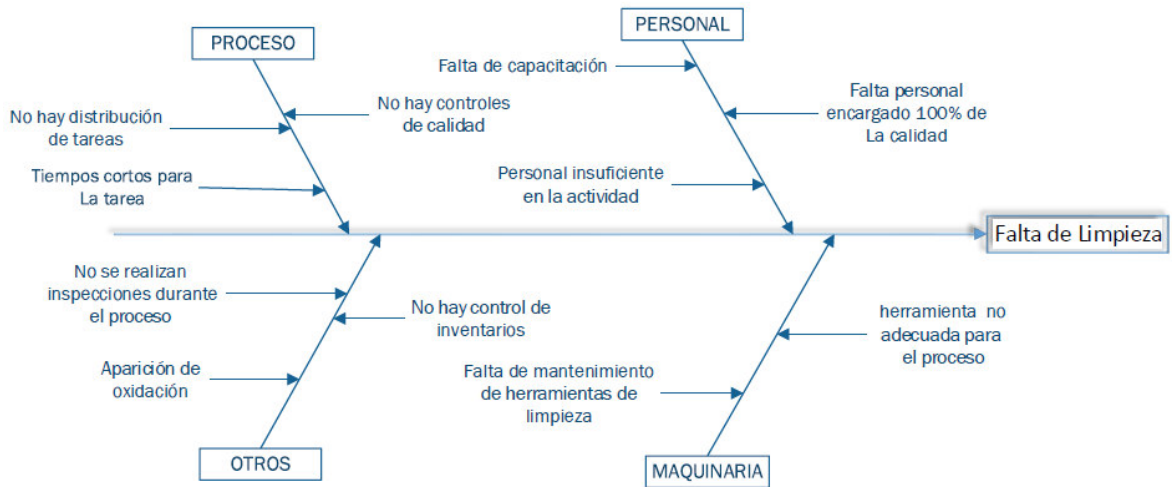
Figura 22. Diagrama casa-efecto, análisis de falta de limpieza de la estructura metálica. Fuente, autor.
