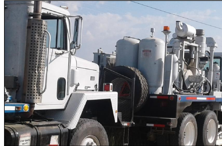
Fotografía 7 Vista del Vibrocami3n. Fuente (PetroBlast SAS, 2017)
