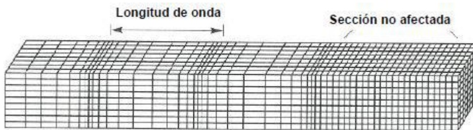
Figura 7 Onda compresional. Fuente (PetroBlast SAS, 2017)
