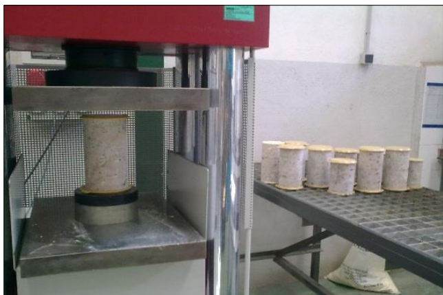
Fotografía 13. Muestras y pruebas a compresión simple
