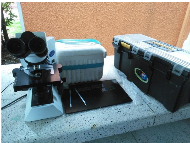
Microcopio, plátina termostática, cava de icopor para transporte de muestras seminales, caja plástica con utensilios de laboratorio. Fuente: Reyes, 2016
