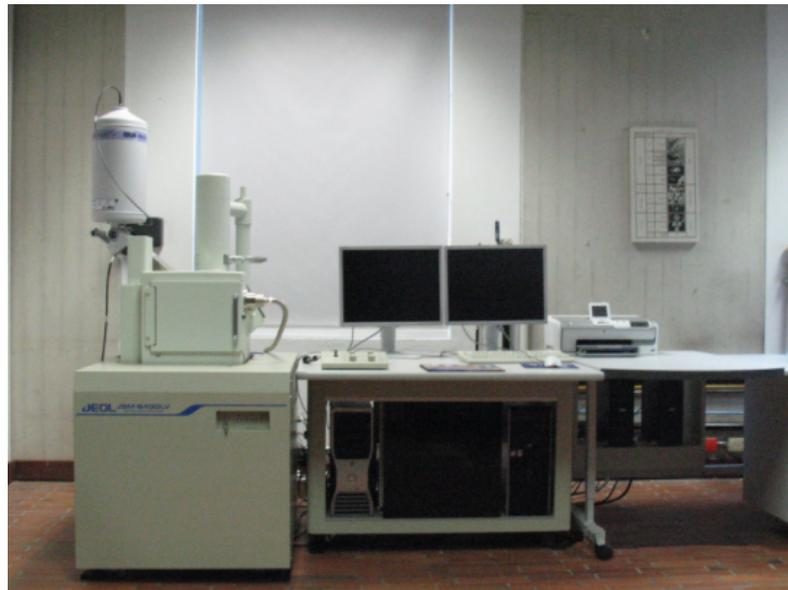
FIGURA 4.7. Microscopio Electrónico de Barrido utilizado en el análisis superficial de las muestras.
