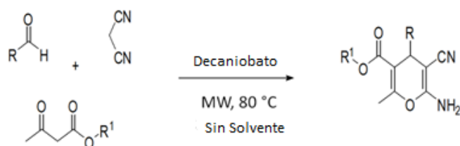
Figura 29. Síntesis del derivado de 6-amino-4 H -pirano a través de un acoplamiento de tres componentes: aldehído, malononitrilo y compuesto de \beta -dicarbonilo.
