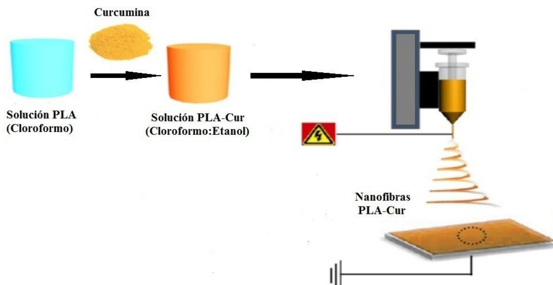
Figura 9. Proceso de electrohilado de fibras de PLA-Cur.
