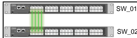
Figura 6. Conexión entre switches por medio de un ISL – Trunking
