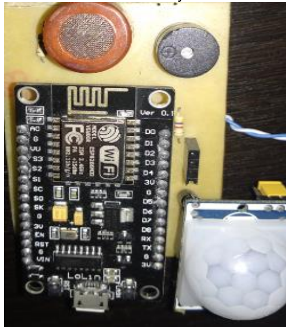
Figura 47. Módulo de monitoreo de incendios y detector de intrusos
