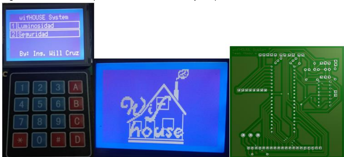
Figura 48. Circuito de prueba, funcionamiento y esquemático PCB
