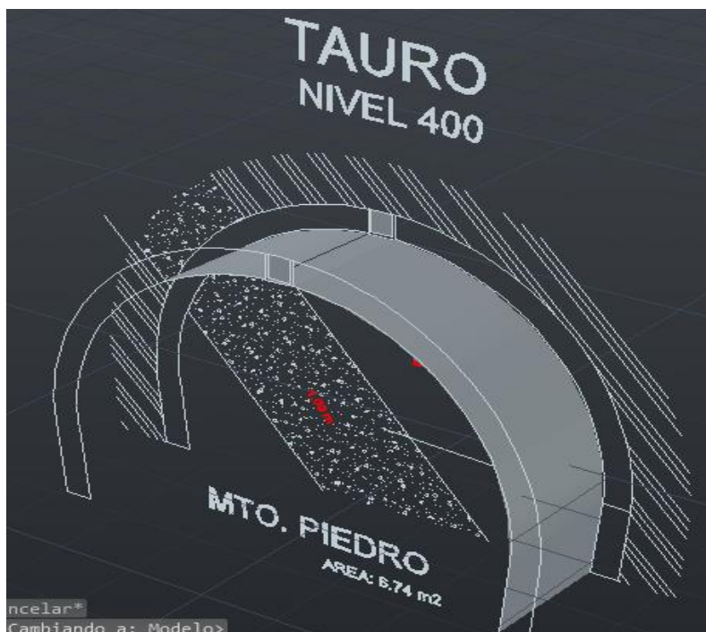
Figura 78. Área de aplicación de carga sobre el techo de la excavación.
