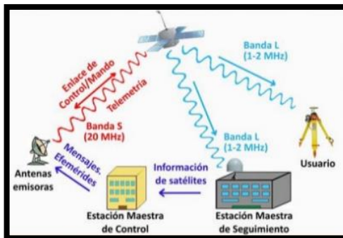
Figura 4. Segmentos de un GNSS
