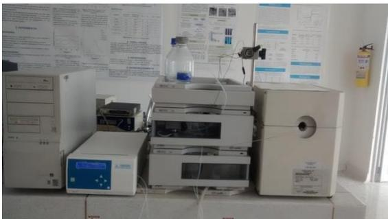
**Figura 11a.** Cromatógrafo de líquidos HP 1100
