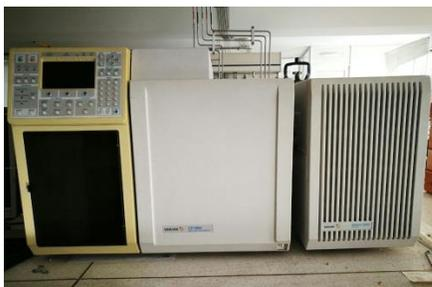
**Figura 12.** Cromatógrafo de gases Varian 3800
