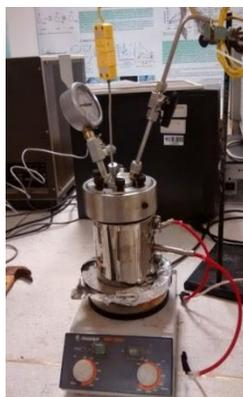
**Figura 10.** Reactor tipo batch
