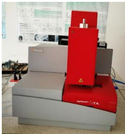
**Figura 7.** Equipo para análisis termogravimétrico Setaram
