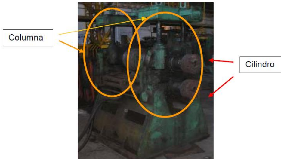
Ilustración 24. columnas y cilindros de la caja laminadora.
