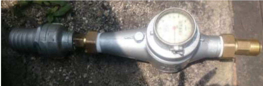
Figura 14. Equipo de medición flujo volumétrico a instalar
