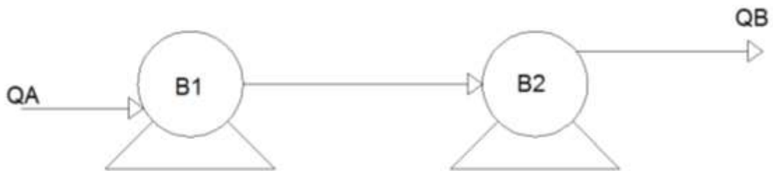
Figura 18. Arreglo de bombas en serie
