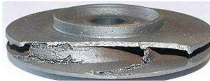
Figura 12. Daños ocasionados por cavitación
