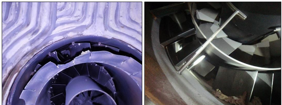
Figura 11. Vistas de álabes internos y externos del quemador.
