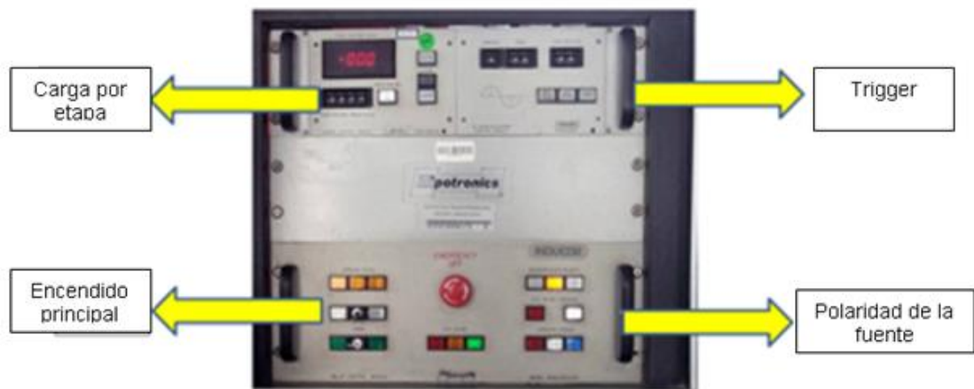
Figura 28. Consola de control.
