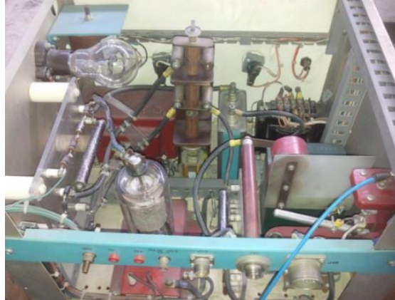
Figura 24. Fuente de alimentación del pulso de disparo.
