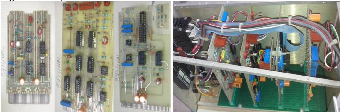
Figura 48. Tarjetas del circuito de control.
