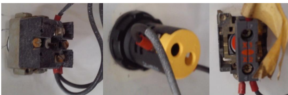
Figura 21. Cambio de circuito de señalización
