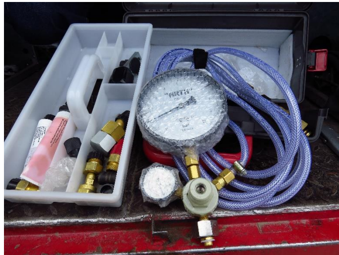
Figura 44. Sistema de llenado de SF 6 . Acoples, mangueras, regulador y manómetro
