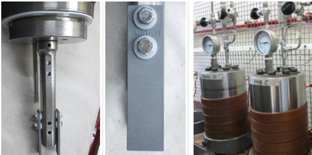
Figura 7. Izquierda: Sistema porta cupones de ensamble; Centro: Cupón gravimétrico instalado; Derecha: Montaje de calentamiento y presurización en autoclave
