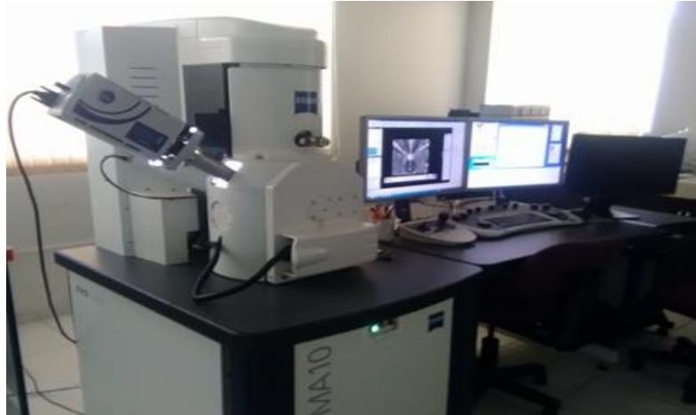
Figura 16. Microscopio electrónico de barrido.
