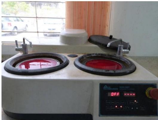
Figura 19. Pulidora metalográfica dace technologies nano 2000T
