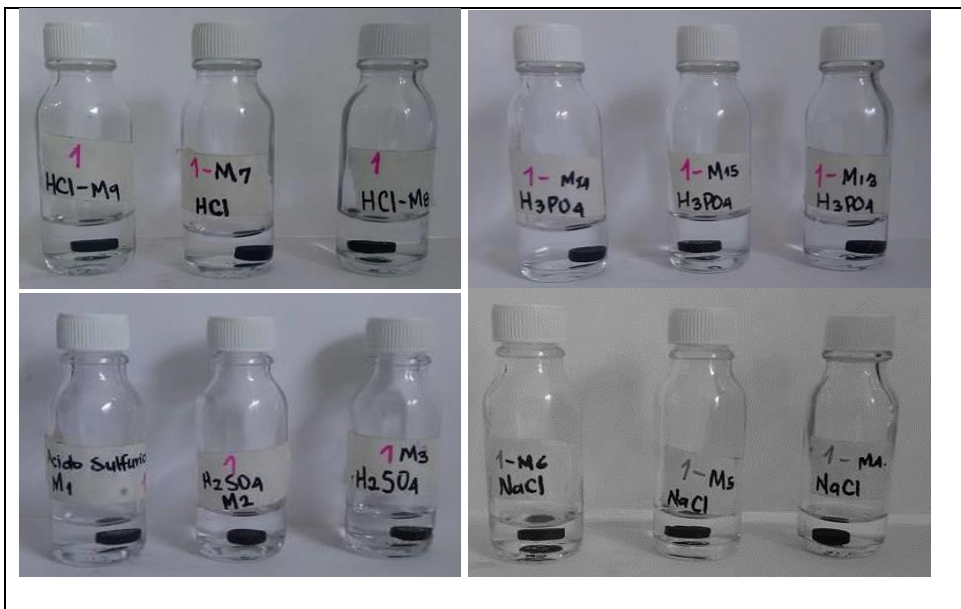
Figura 57. Probetas de 316 con adiciones de Ti y Mo en soluciones.
