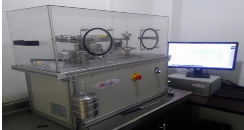
Figura 24. Tribómetro Microtest MT/60/NI
