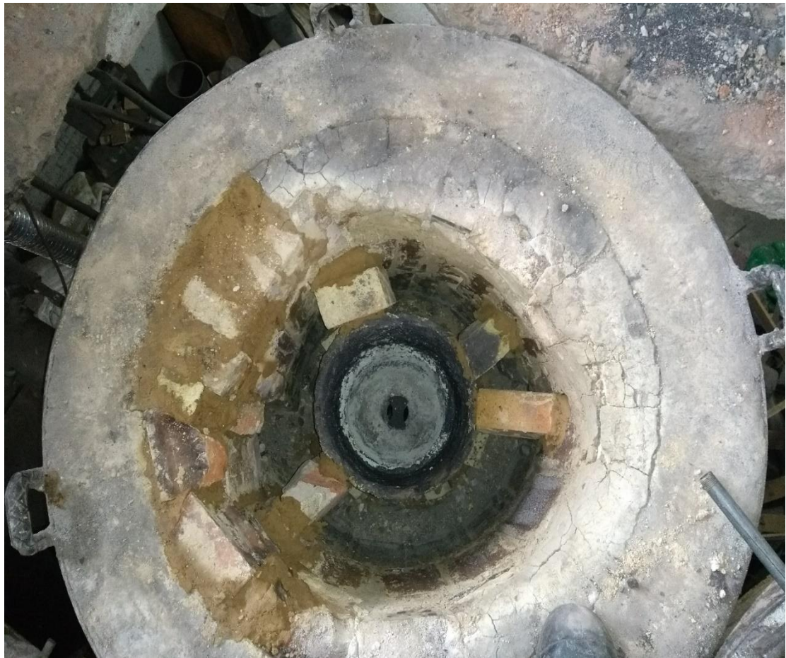
Figura 32. Modificación del distribuidor con un crisol de carburo de silicio
