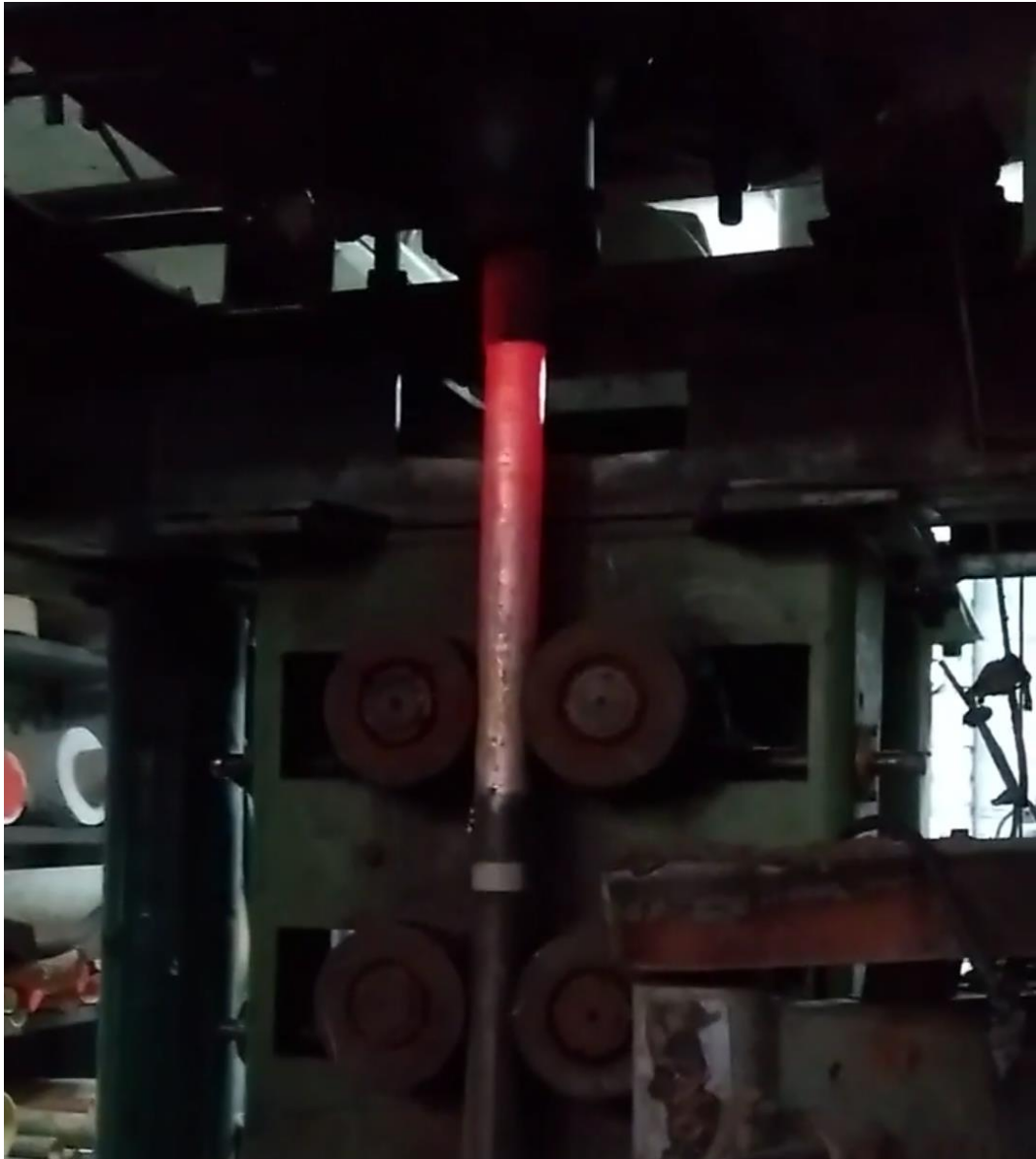
Figura 41. Extracción de la barra perforada
