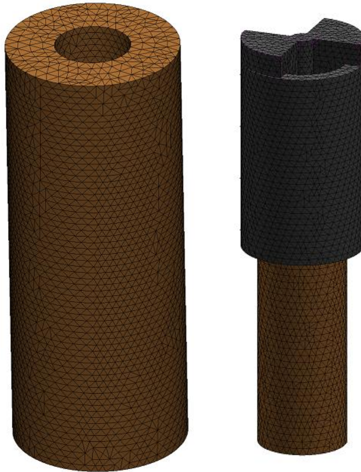
Figura 44. Generación de mallado del producto final y del molde.
