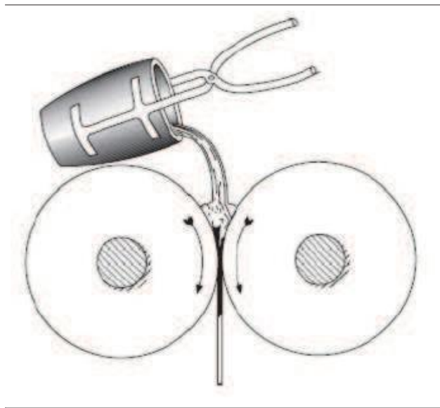
Figura 4. Esquema de la máquina de colada continua proyectada por Bessemer
