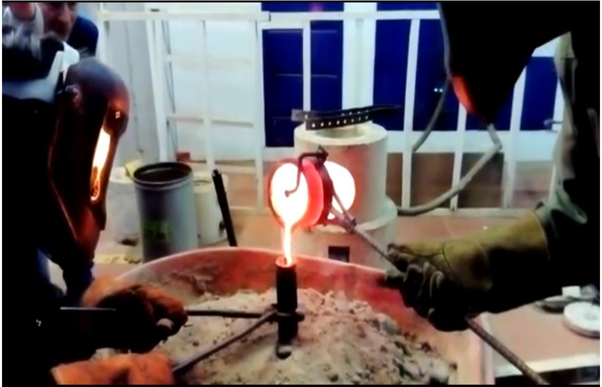
Figura 28. Realización de la prueba de simulación de colada continua.
