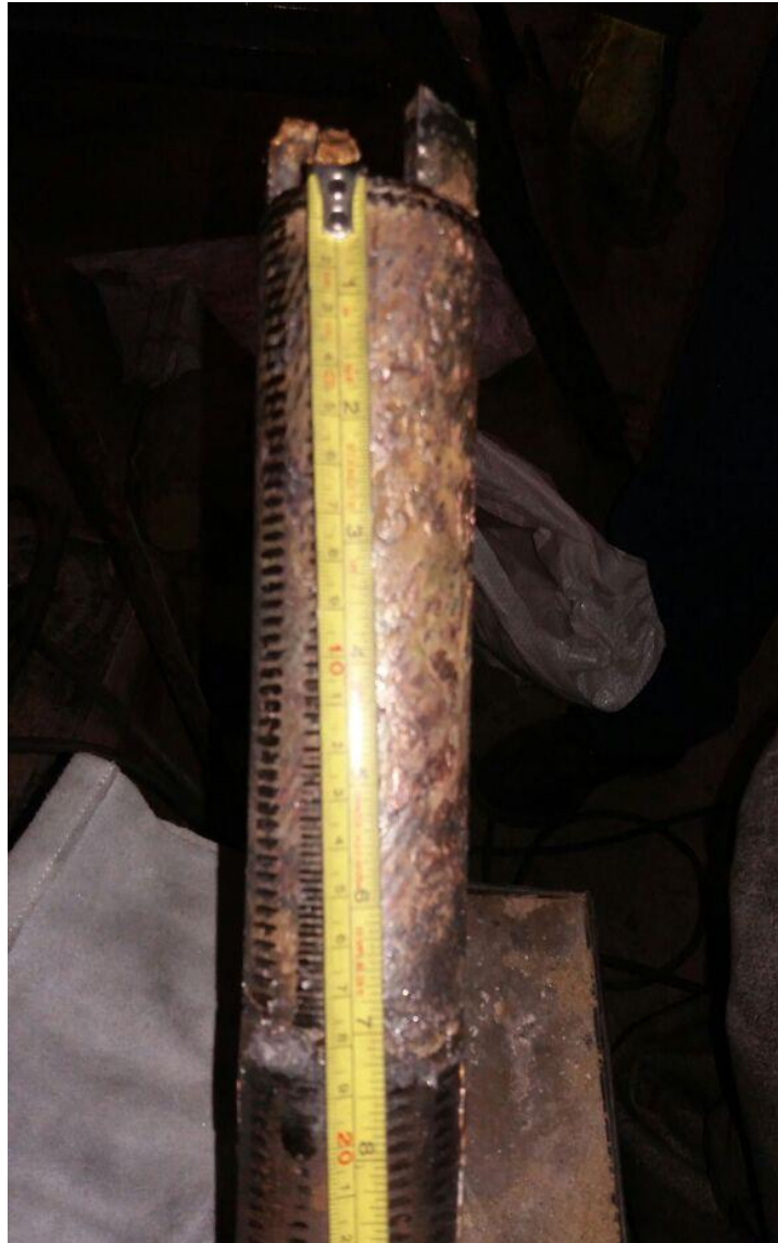
Figura 42. Barra perforada obtenida por el sistema de colada continua, vista lateral.
