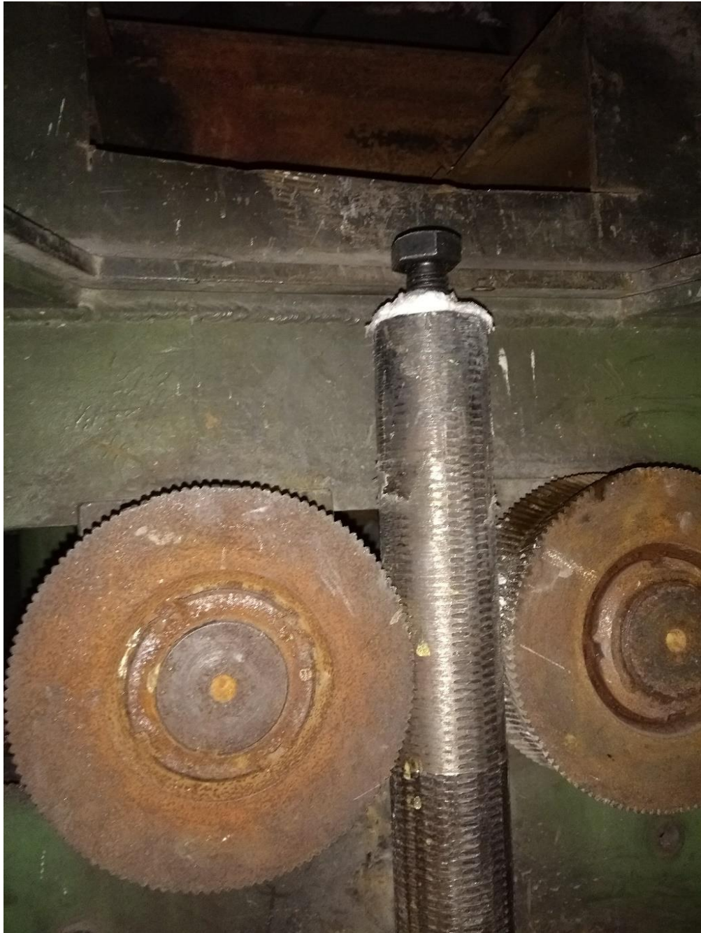
Figura 39. Barra falsa y rodillos extractores.
