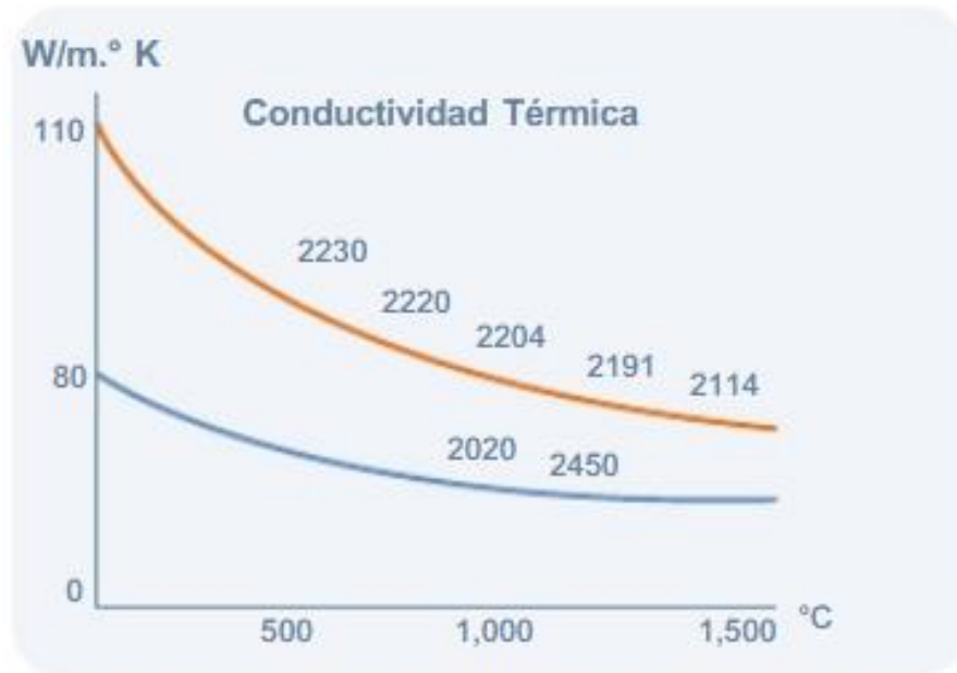
Figura 23. Conductividad térmica de diferentes tipos de grafito.
