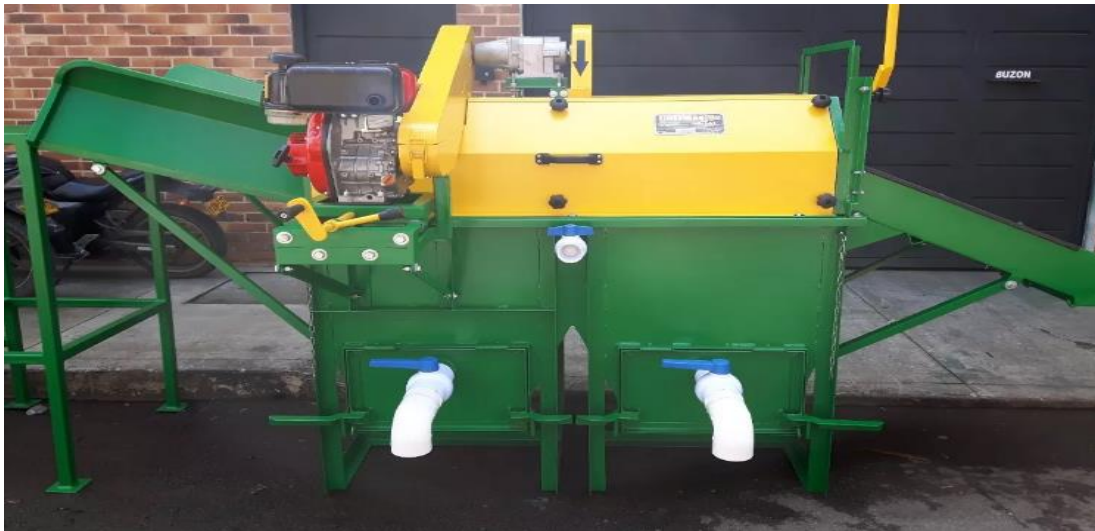
Figura 7 Lavadora de papa 30 bultos/hora, marca INGEMAQ
