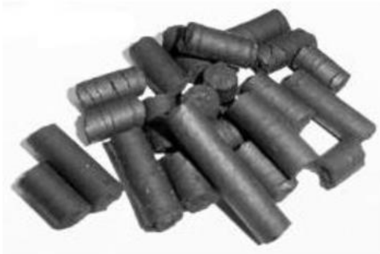
Figura 12: Esquema que muestra el pellet de biochar
