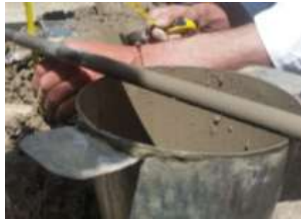
Ilustración 28. Medición de asentamiento
