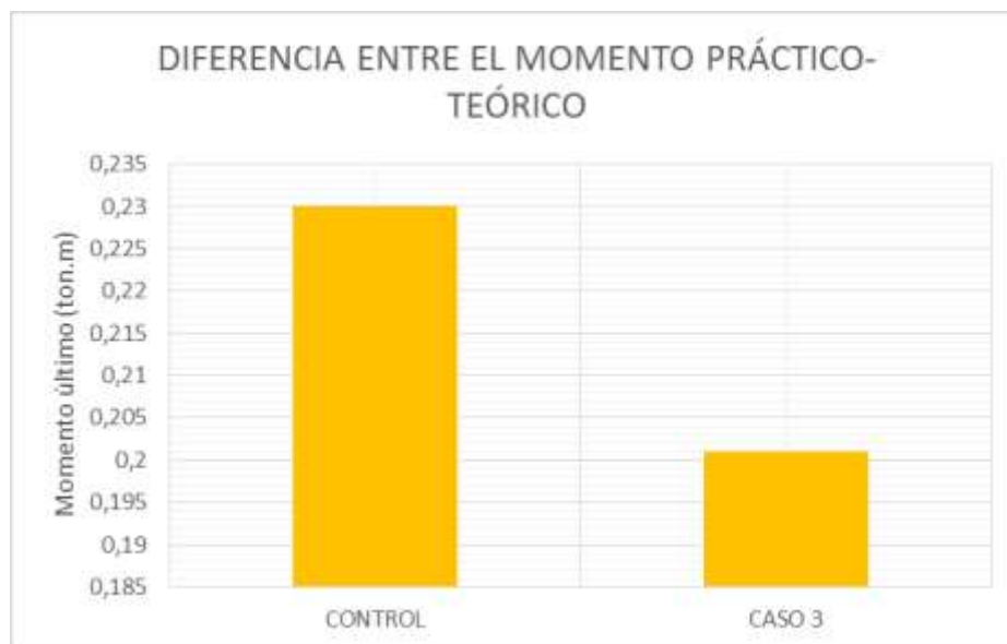
Ilustración 39. Momento ultimo soportado por las vigas reforzadas.
