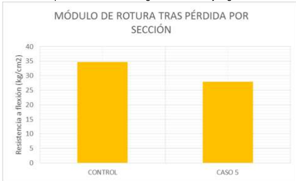
Ilustración 44. Comportamiento de las vigas del caso 5 y vigas de control.
