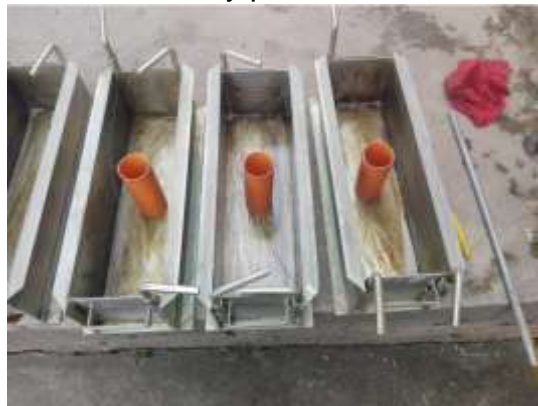
Ilustración 29. Engrasado de moldes y posicionamiento de los tubos.
