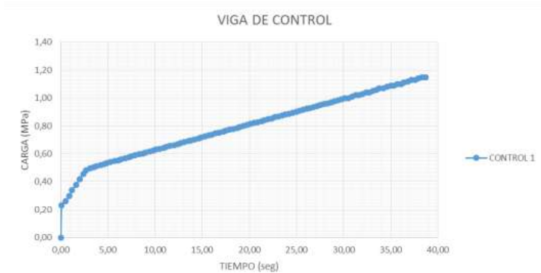
Ilustración 53. Carga vs Tiempo- Viga de control
