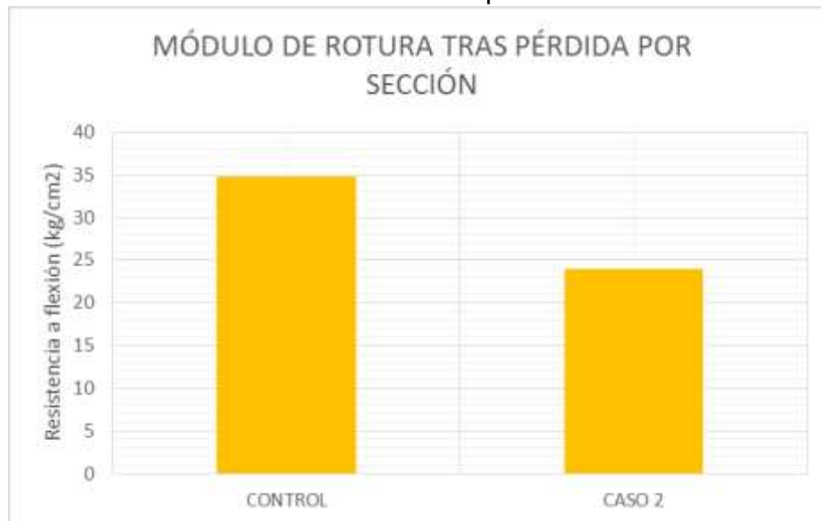
Ilustración 36. Perdida de resistencia a flexión para el caso 2.
