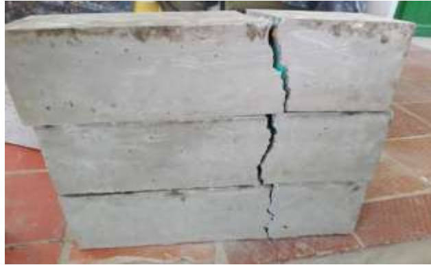
Ilustración 47. Rotura total de la viga para el caso 6.
