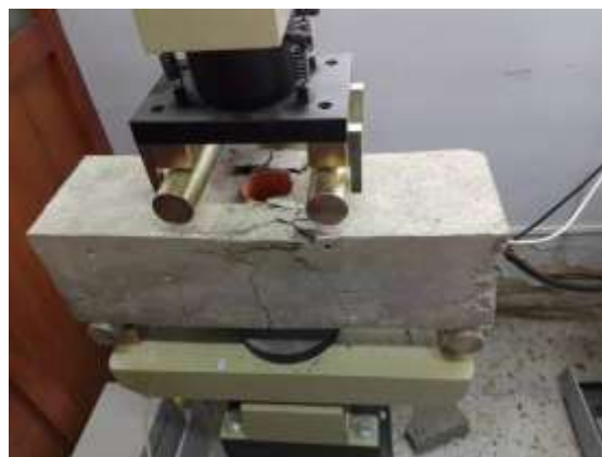
Ilustración 37. Vigas con tubo de 2" y 2 barras de refuerzo #2 pos-falla
