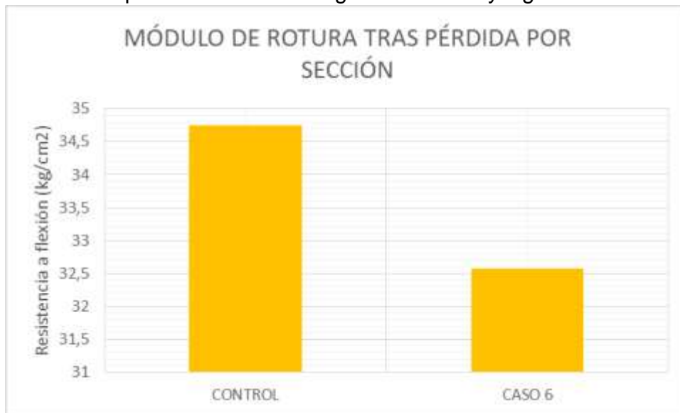
Ilustración 46. Comportamiento de las vigas del caso 6 y vigas de control.
