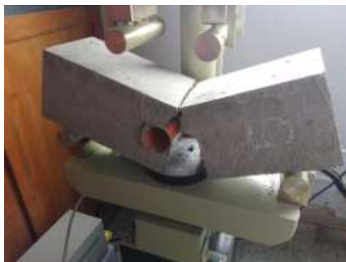
Ilustración 35. Vigas con tubo de 2" pos-falla
