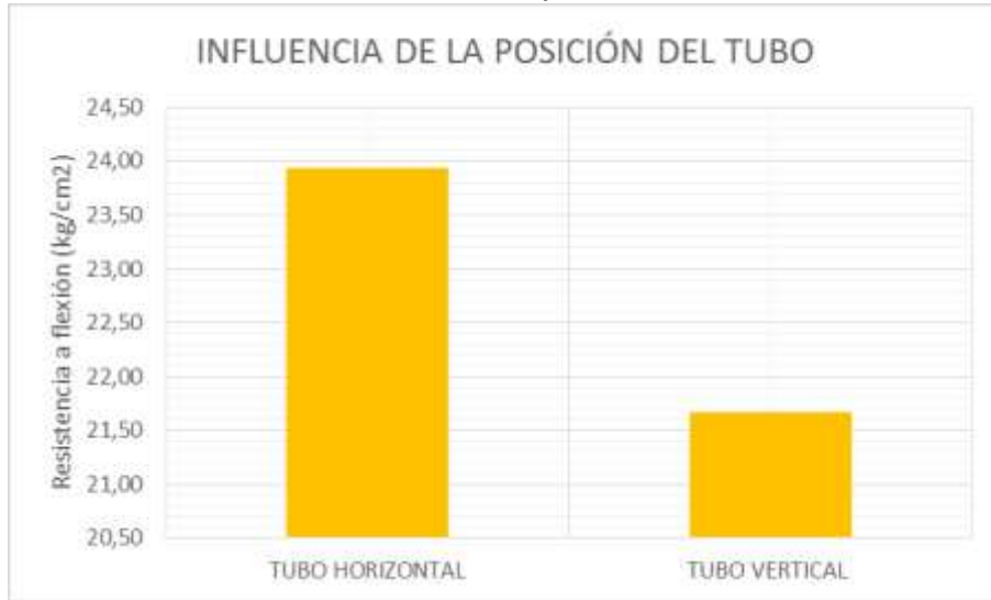
Ilustración 48. Influencia en la variación del posicionamiento del tubo de 2”.
