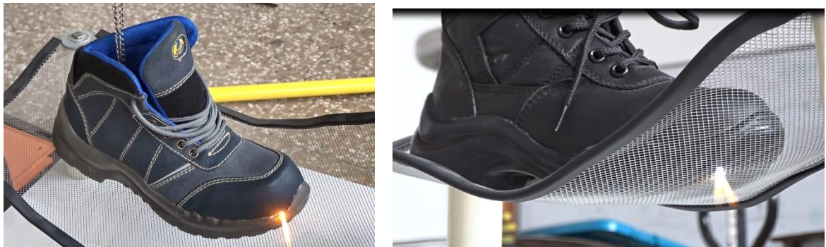
Figura 26. Ensayo a calzado dieléctrico que presentó una falla.
