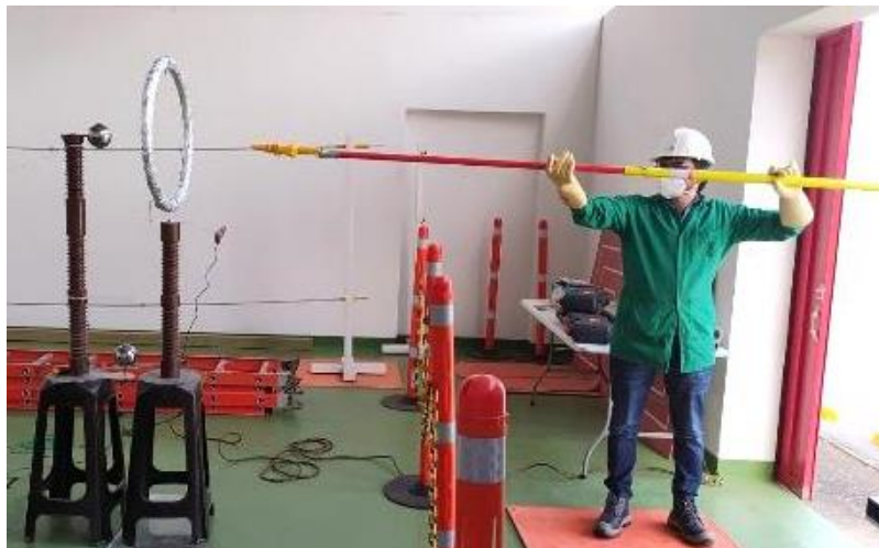
Figura 23. Montaje de verificación de pinza puesta a tierra.
