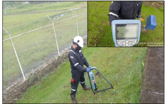
Figura 54. Inspección ACGV segmento 56-1
