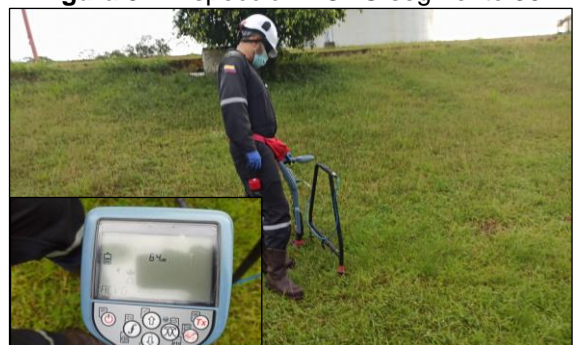
Figura 34. Inspección ACGV segmento 35
