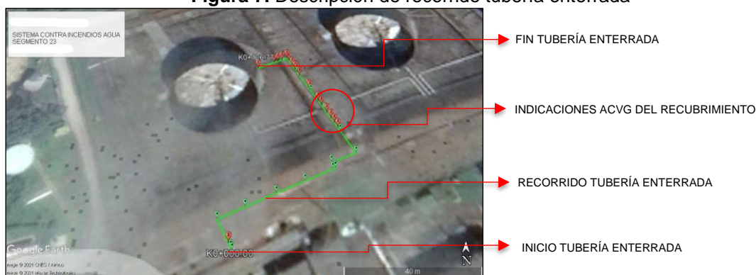
Figura 7. Descripción de recorrido tubería enterrada
