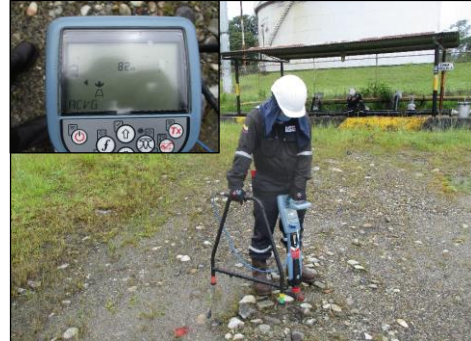
Figura 66. Inspección ACGV segmento 69
