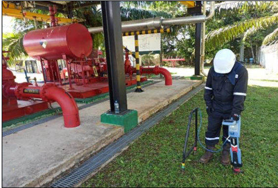
Figura 3. Inspección ACVG con marco A
