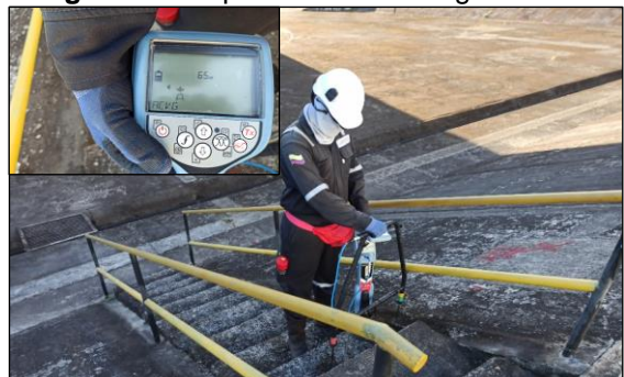
Figura 30. Inspección ACGV segmento 29
