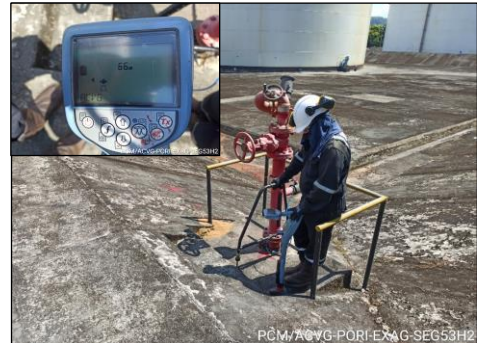
Figura 50. Inspección ACGV segmento 53-2
