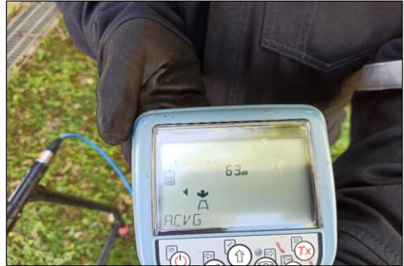
Figura 4. Visualización de indicación ACVG en pantalla
