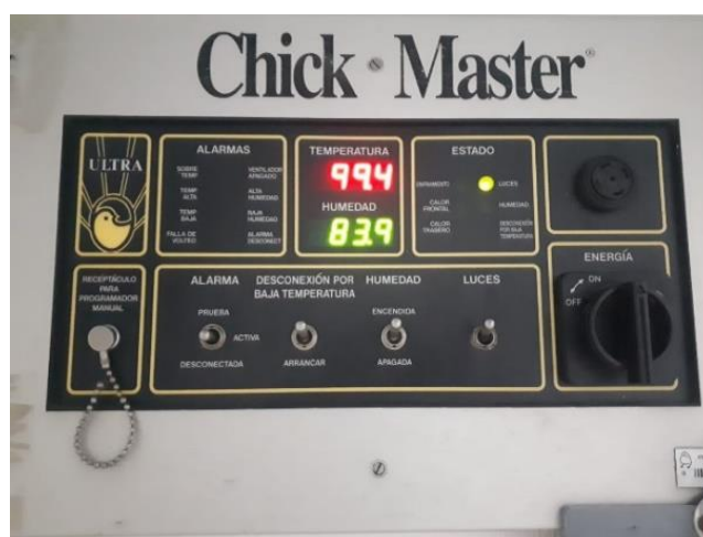
Imagen 18. Tablero monitoreo de temperatura y humedad de incubadoras
