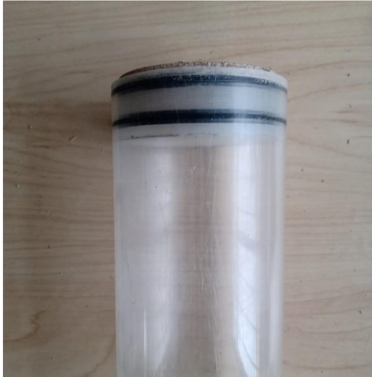
Figura 47. Sello hermético del embolo de inyección
