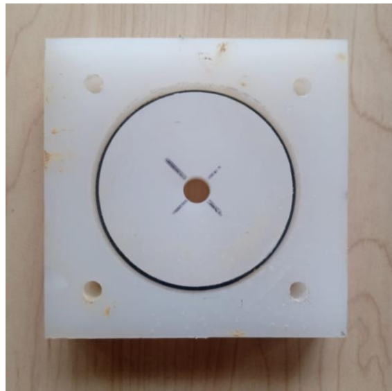
Figura 39. tapa de ingreso de aire
