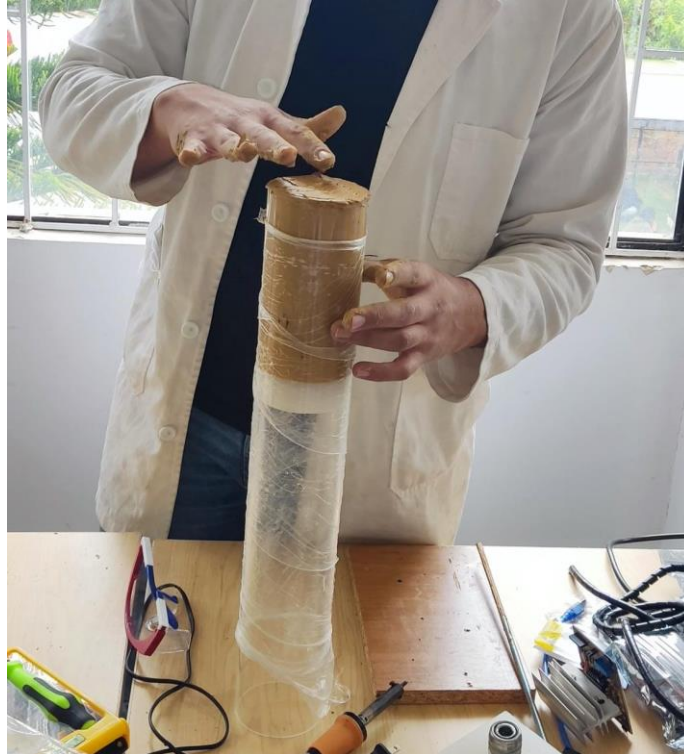
Figura 55. cargado de material en el sistema de inyección
