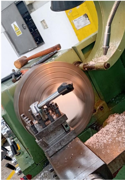
Figura 38. Construcción tapa ingreso de aire sistema de inyección
