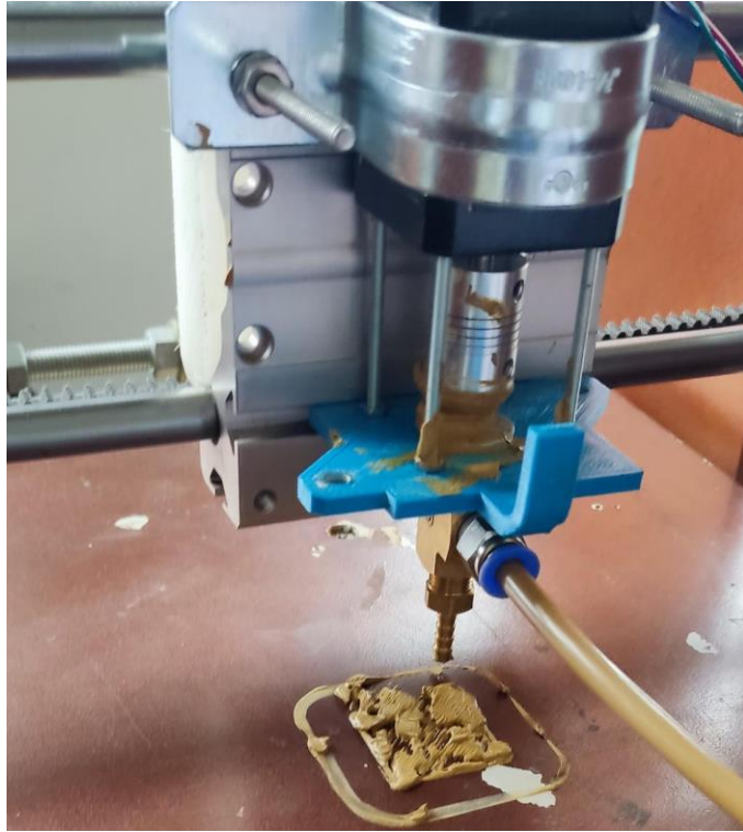
Figura 20. fallas prototipo de extrusión inicial
