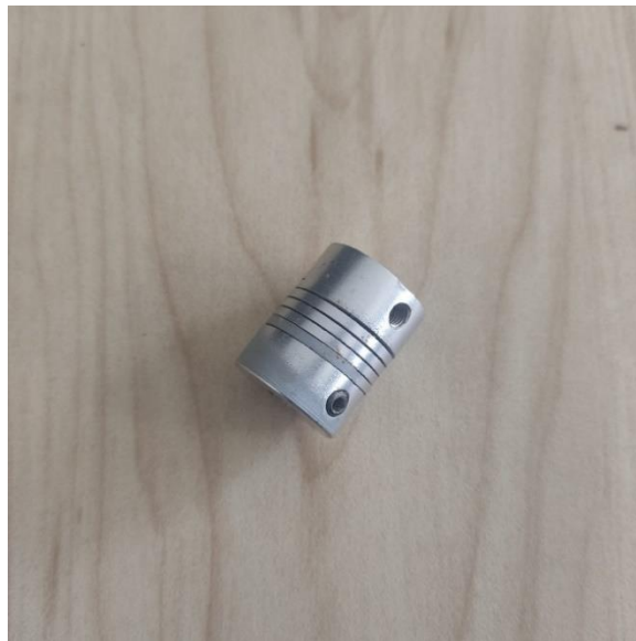
Figura 23. Acople flexible motor nema 23-tornillo dosificador
