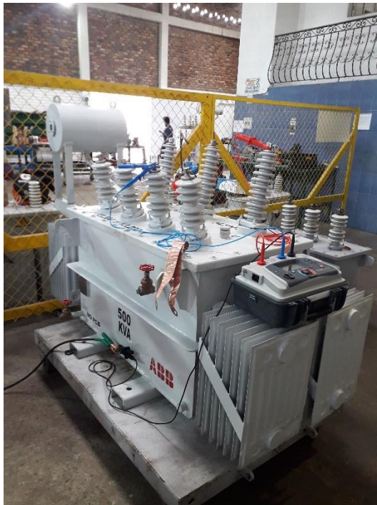
Ilustración 30. Pruebas piloto a transformador de 500 KVA
