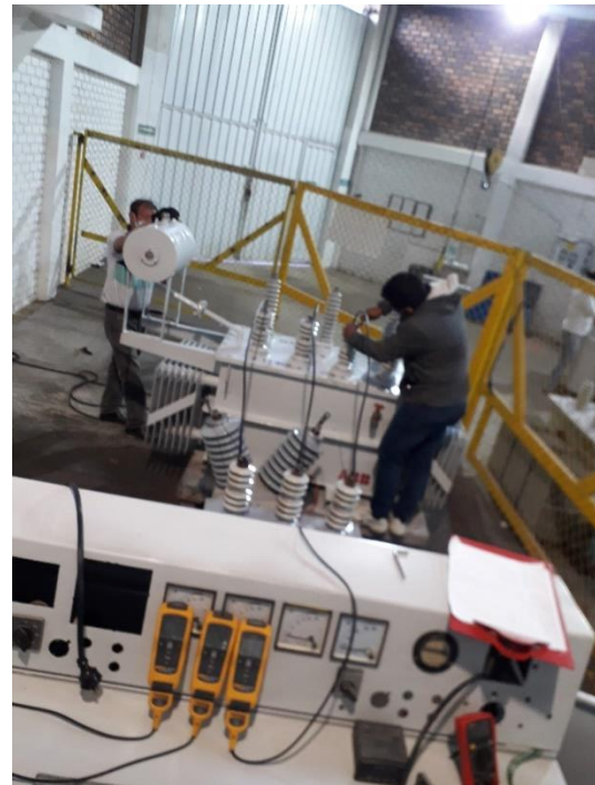
Ilustración 30. Pruebas piloto a transformador de 500 KVA
