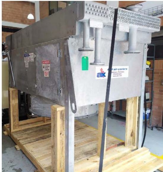
Figura 16. Aero enfriador de dos secciones
