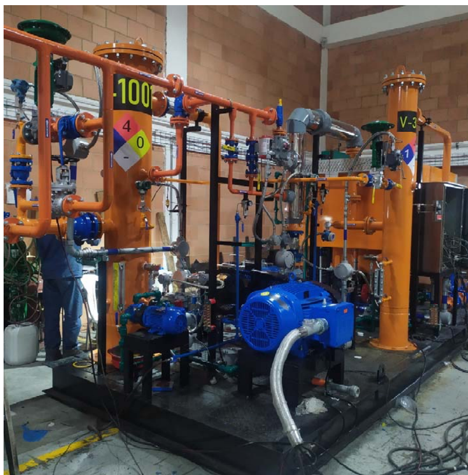
Figura 82. Ensamblaje final unidad recuperadora de vapores (URV)
