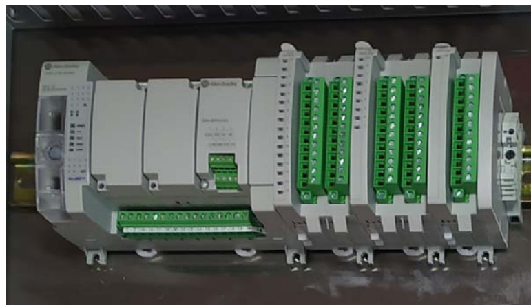
Figura 59. PLC micro 850 de Allen Bradley con módulos de expansión
